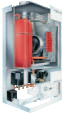
**Fig. 22 : Chaudière murale gaz à condensation Vitodens 100 à surfaces d'échange Alu-Sil et brûleur surfacique radiant en acier inoxydable**
