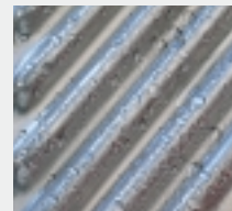
Surfaces d'échange Crossal en acier inoxydable austénitique
